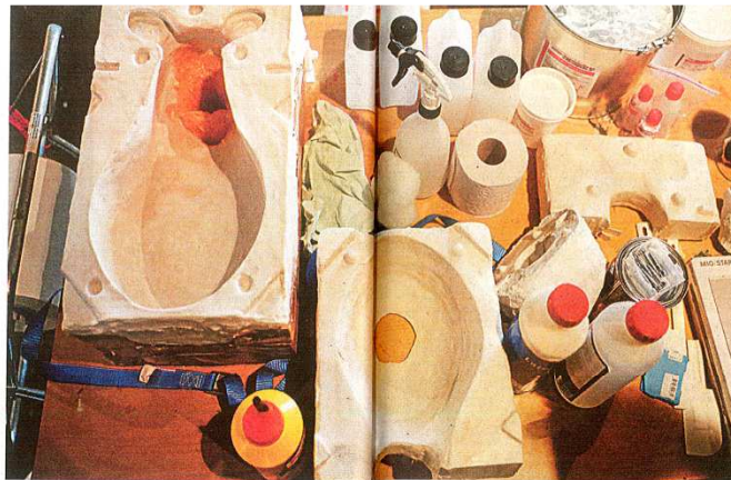
Des moules en plâtre servent à couler les personnages dans du silicone.
